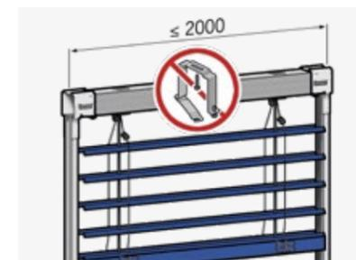
El sistema de persianas autoportante protege el aislamiento del dintel y minimiza los costes de servicio. Hasta un ancho de 2000 mm, el sistema no necesita fijación para el puente. El aislamiento permanece intacto y se reduce la transmisión de ruido.
